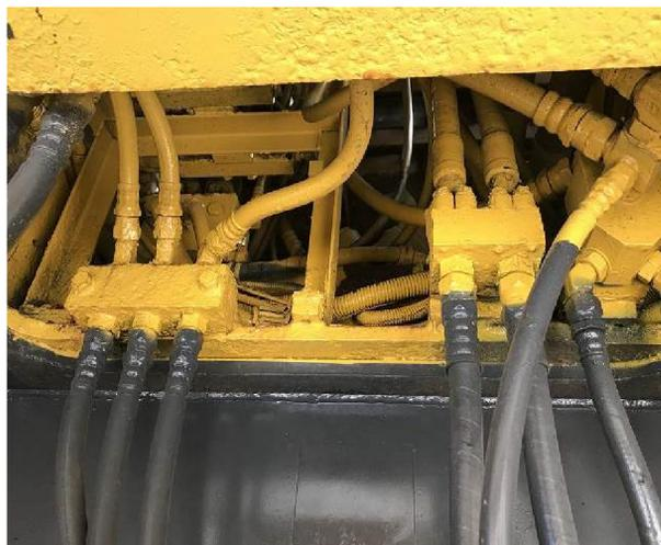
ホース、配管類劣化 錆、腐蝕散見
