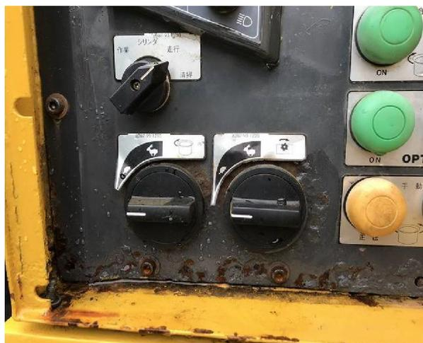
操作パネル下部腐蝕 ボルト1本折損
