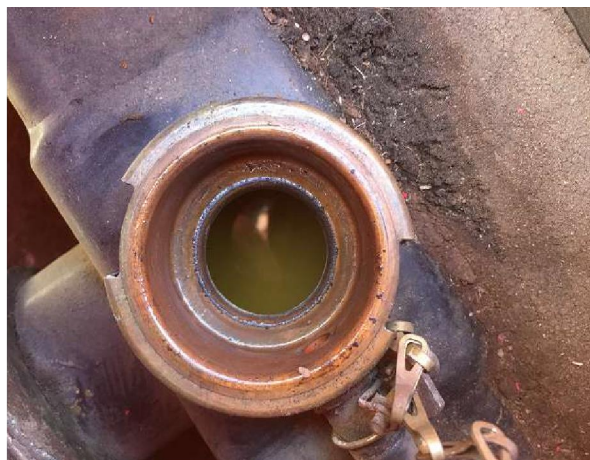
クーラント劣化による変色
