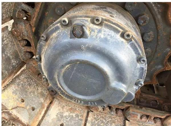
走行減速機 (右) ドレンボルト不良。異径ボルト取り付けの為取り外し困難
