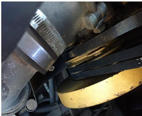
Vベルト劣化、緩み ファンベルト新品
