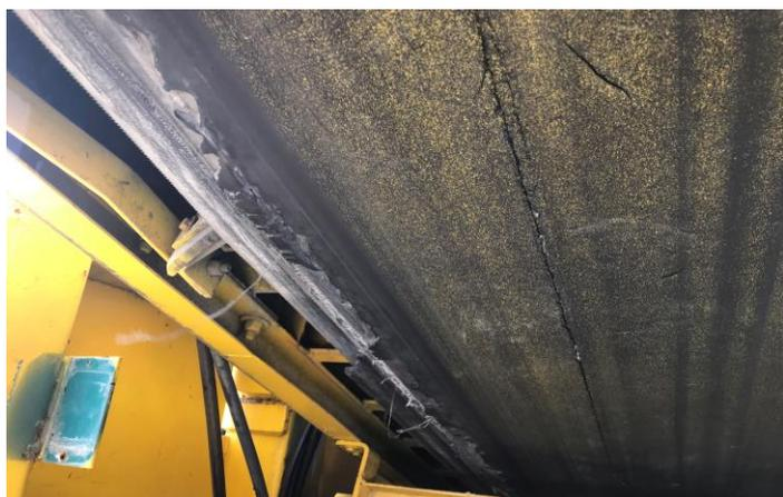
コンベアーベルトゴム損傷
