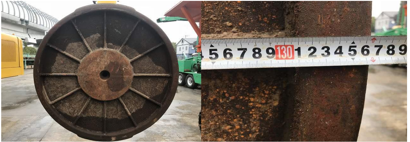
マグネット裏側：寸法写真（直径1360）
