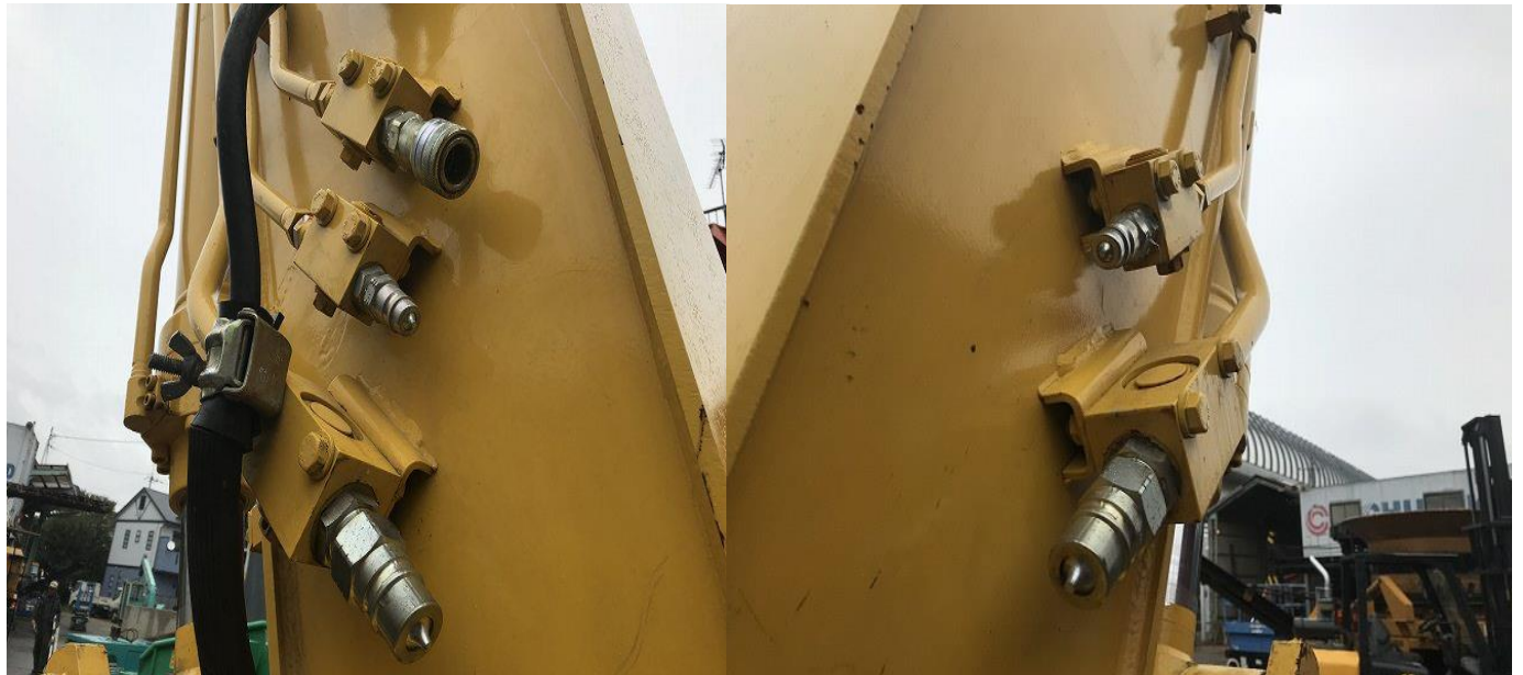
アタッチメント配管（カプラサイズ 1 inch及び 4部）
