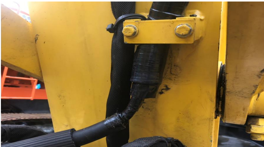
マグネット配線修理済み
