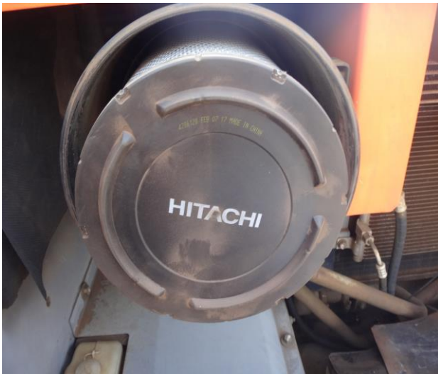
エアエレメント状況写真
