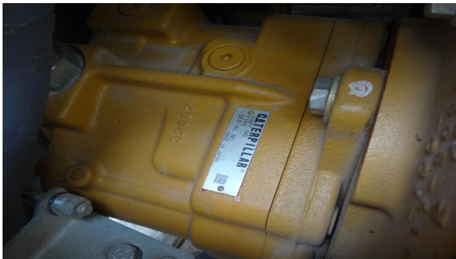
油圧ポンプ状況写真
