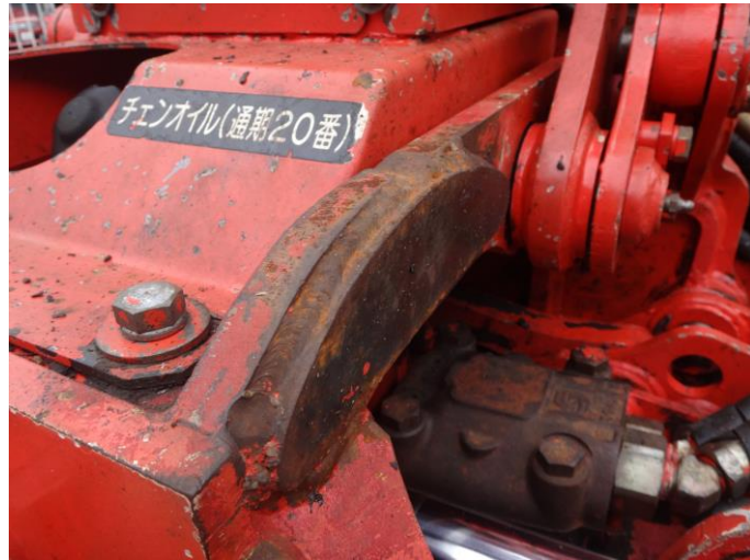
グラップルフレームパッチ修正後側
