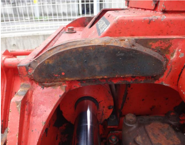
グラップルフレームパッチ修正前側
