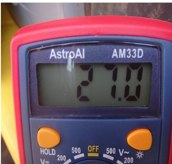
バッテリー電圧測定写真 (E/G始動後)
