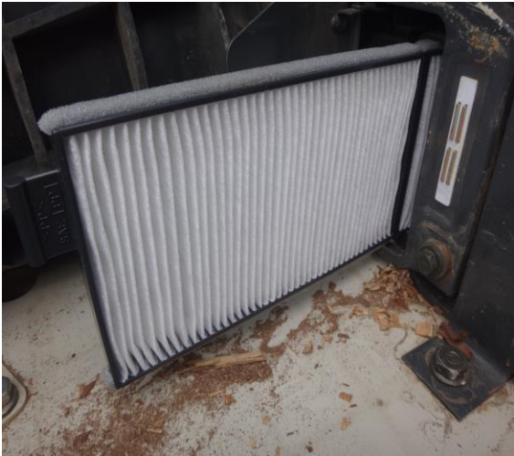
エアコン内気フィルター交換後
