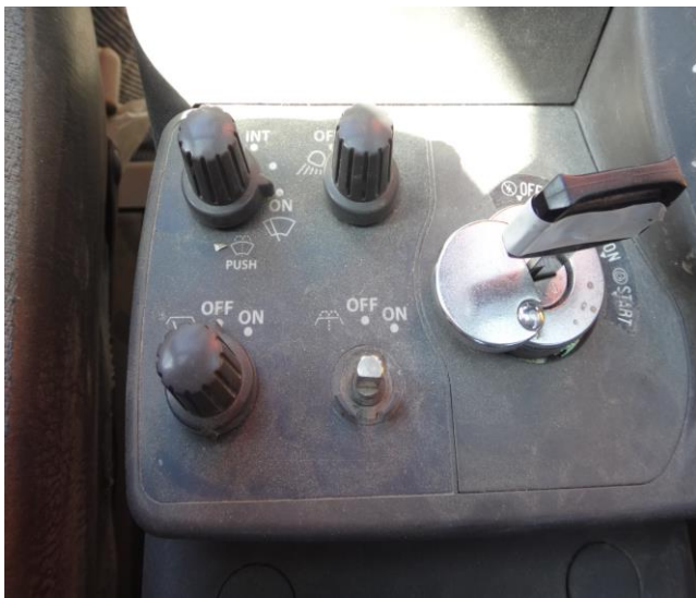
天窓ワイパースイッチ状況写真
