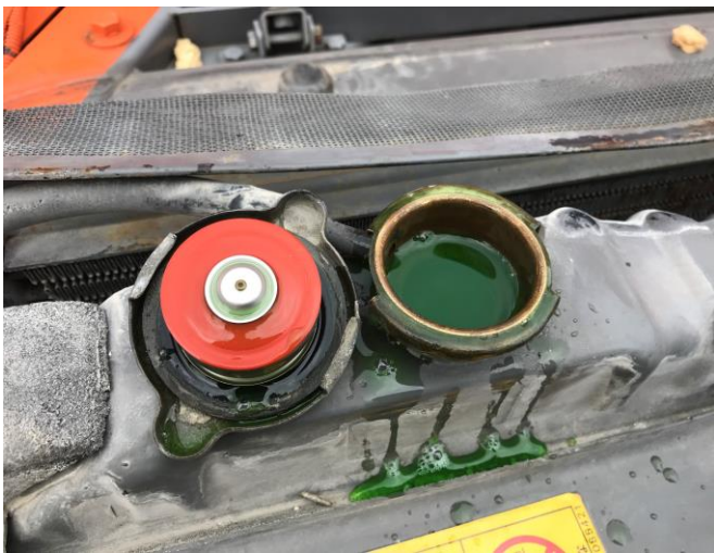
冷却水状況写真 (LLC)
