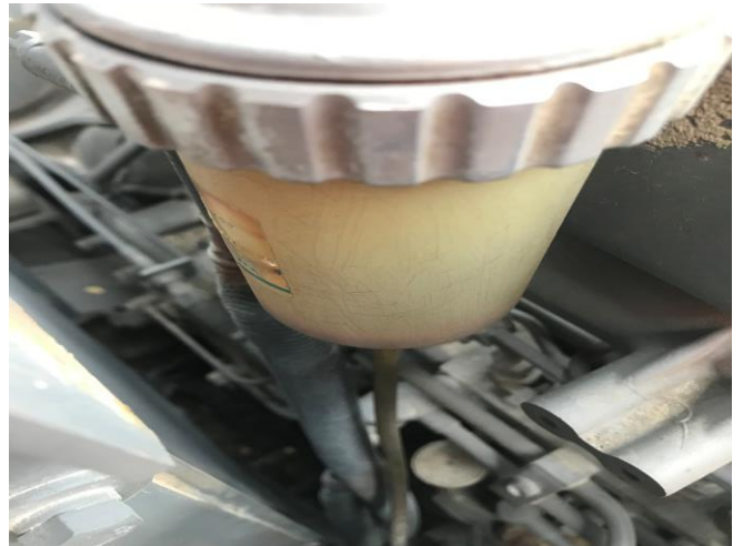
ウォーターセパレーター状況写真
