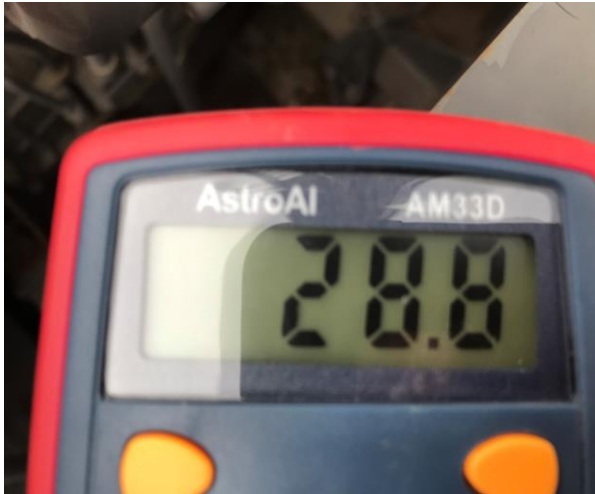
オルタネーター電圧状況写真
