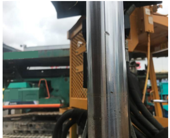
HIAB起状シリンダーロッド打痕 状況写真 (拡大)
