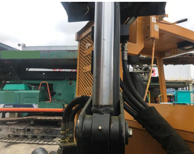
HIAB起状シリンダーロッド打痕 状況写真
