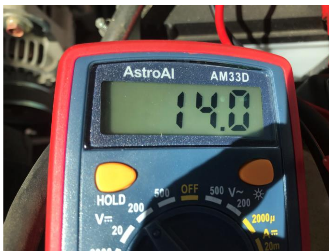
バッテリー電圧測定写真 (E/G始動後)
