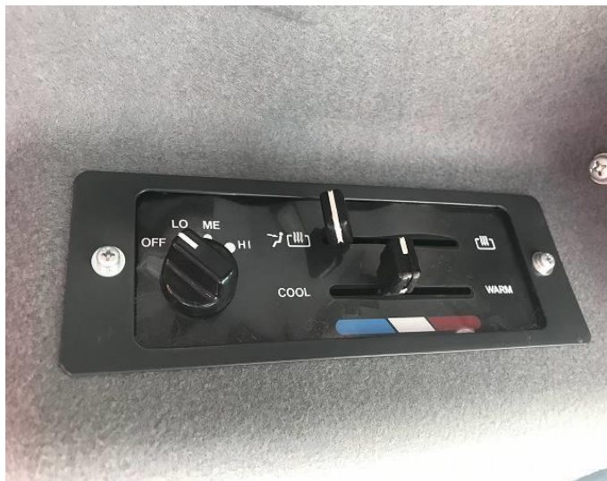
ヒーターコントロール写真
