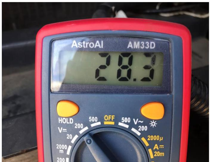
バッテリー電圧測定 (E/G始動前 : E/G始動後)
