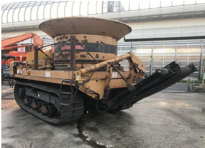
ロングベルコンへ改造 & 磁選機取り付け
