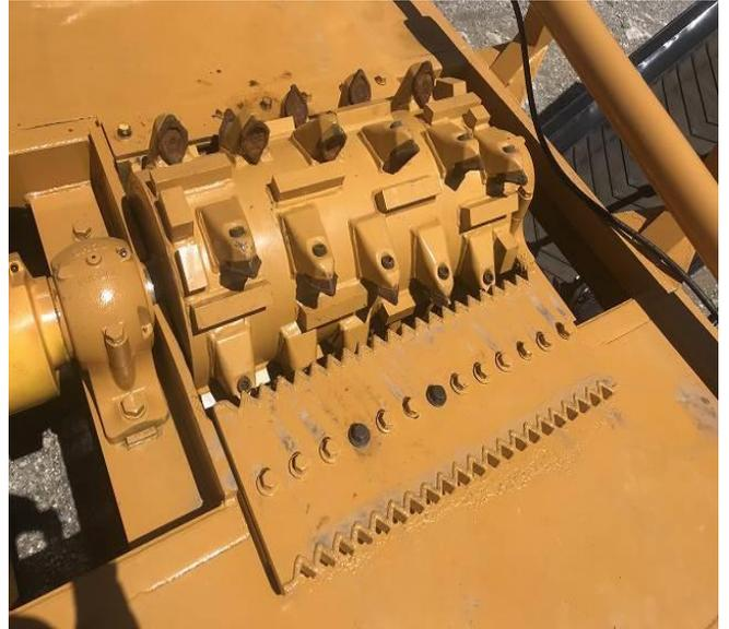
破砕ドラム、ベアリング&カップリング 固定歯 交換
