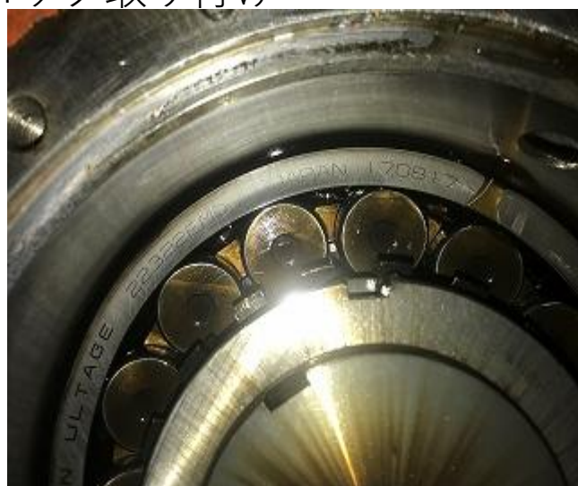
ドラムベアリング左右交換
