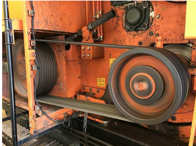
破碎駆動ベルト交換
