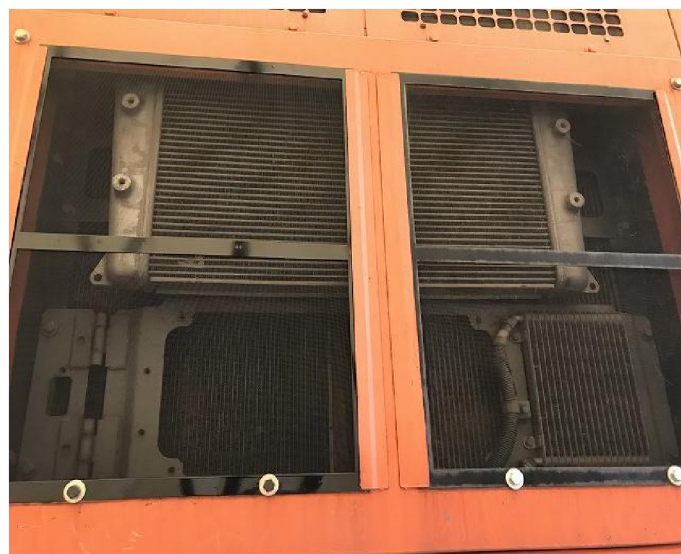
ラジエーター防塵網新品交換
