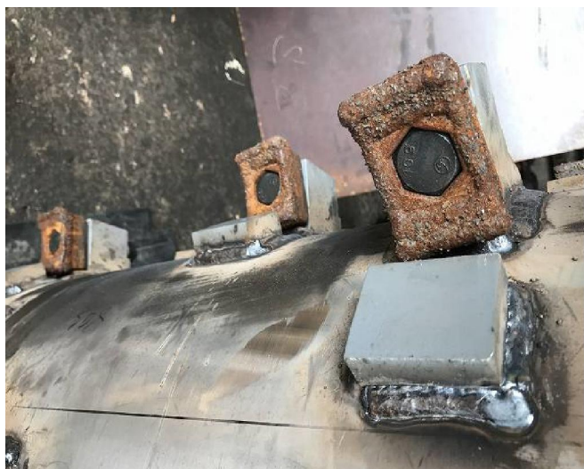
ビット&ビットブロック取り付け
