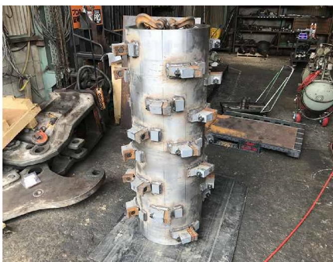
ビット&ビットブロック取り付け
