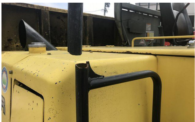
前側支柱欠損
