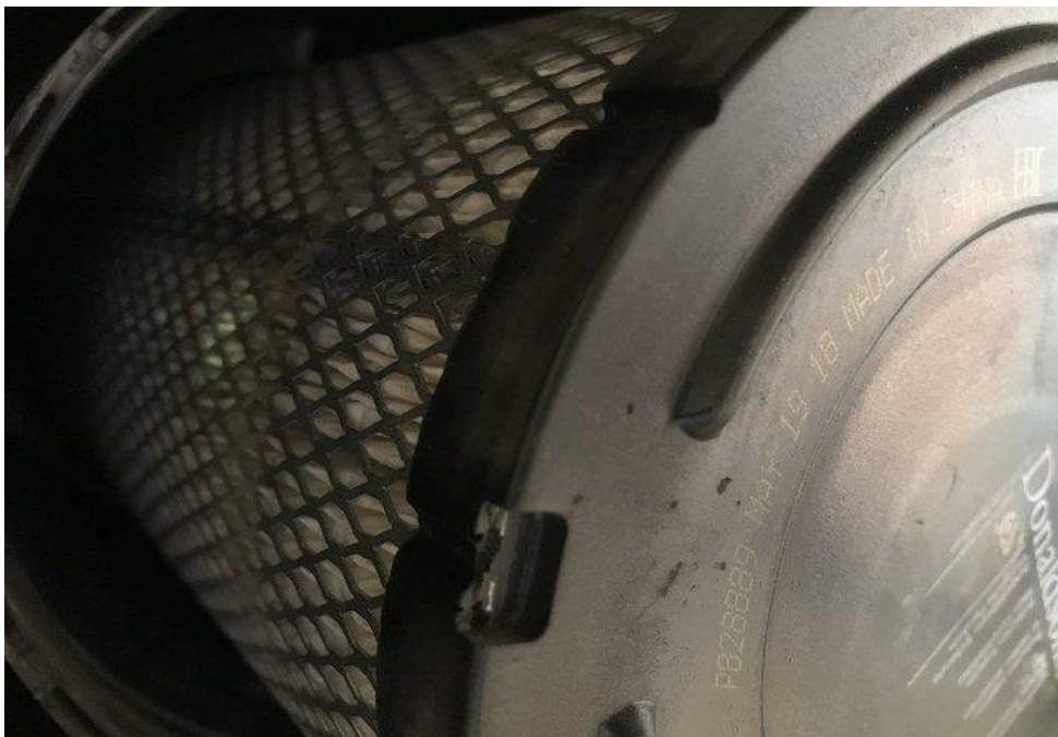
エアエレメント交換
