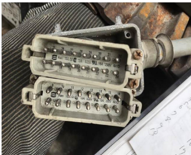
ラジコン配線コネクタ交換及び配線修正
