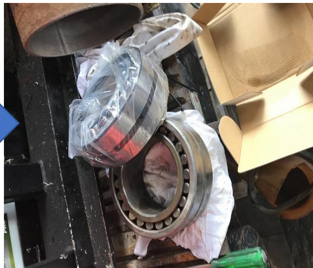
破碎機シャフトリアベアリング交換
