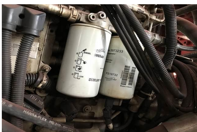
燃料エレメント交換
