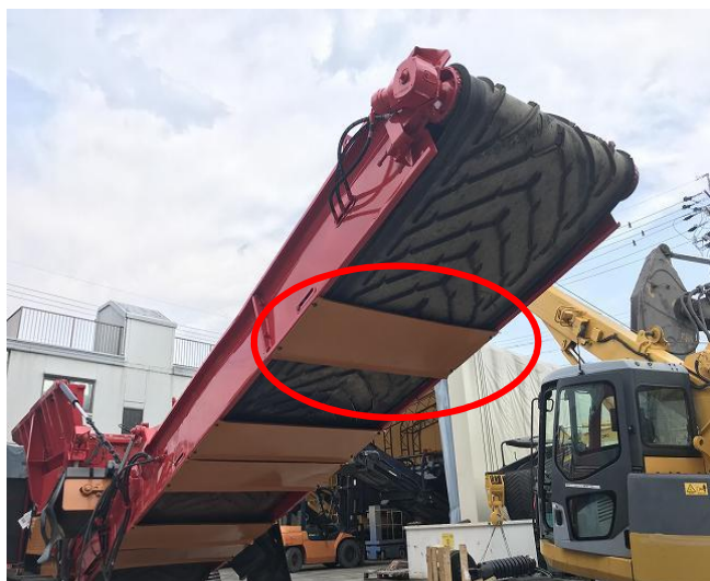
ベルコン下部カバー板金修正
