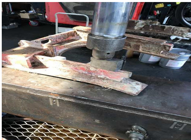
シャフト固定フレーム変形修正
