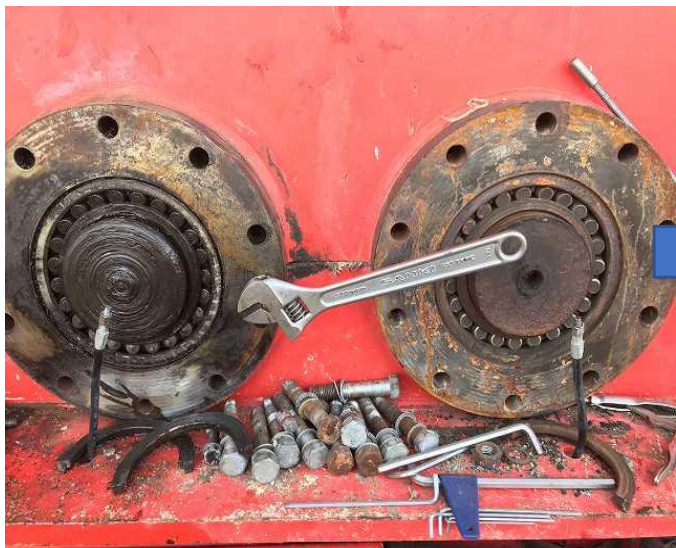
破碎機シャフトリアベアリング交換
