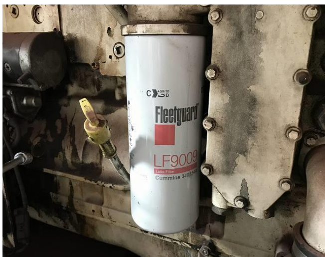
エンジンオイルエレメント交換
