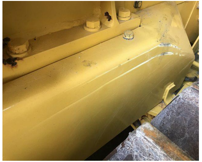
配管カバー傷
