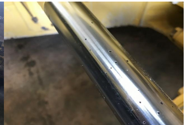
左右アングルシリンダー油洩れ及びロッド打痕
