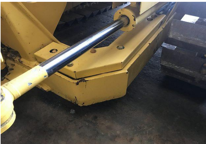
左右アングルシリンダー油洩れ及びロッド打痕
