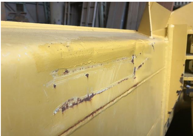
排土板裏側凹み
