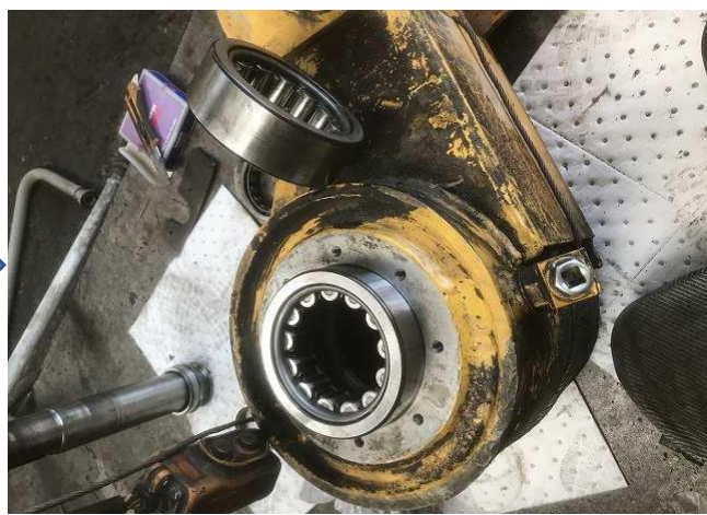
内部ベアリング交換
