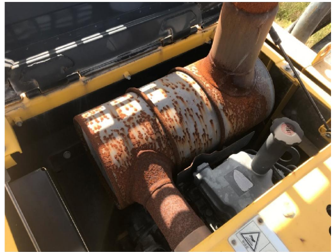
マフラー錆散見
