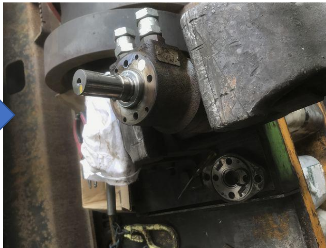
磁選機モーター油漏れ修理
