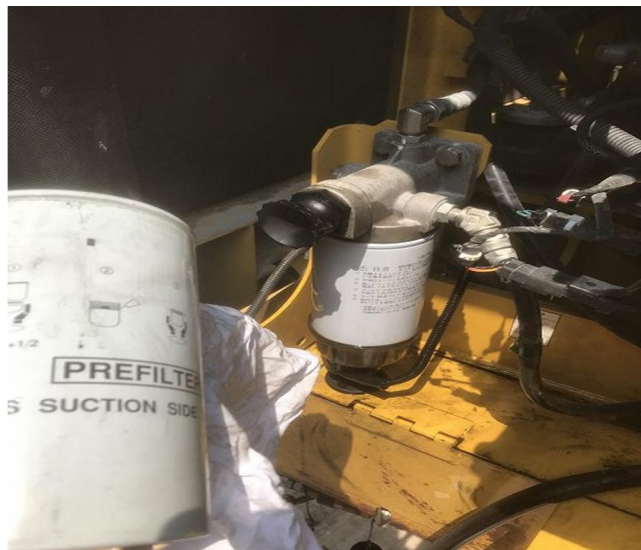
燃料エレメント交換
