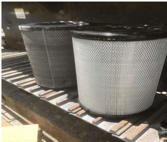
エアエレメント交換
