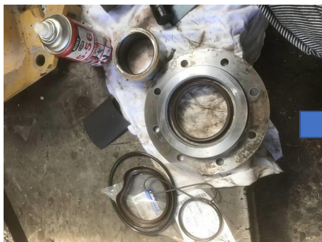
クラッシャーモーターシール交換
