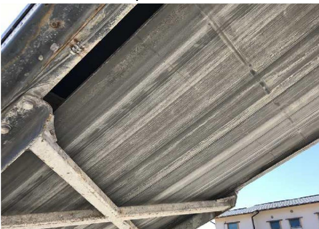
ベルコンゴム劣化 小傷散見
