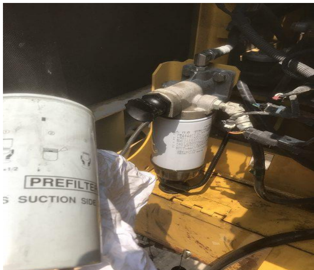
燃料エレメント交換
