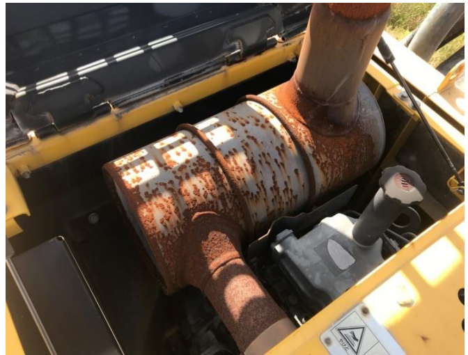
マフラー錆散見
