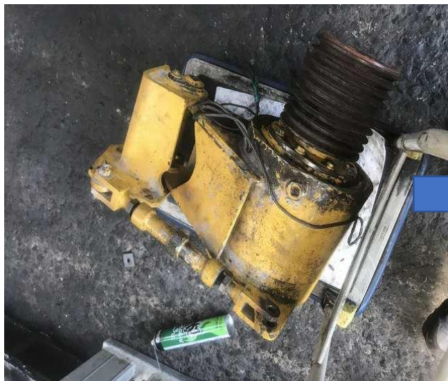
クラッシャーモーター油漏れ修理
