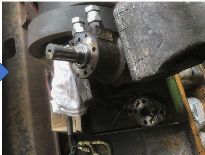
磁選機モーター油漏れ修理
