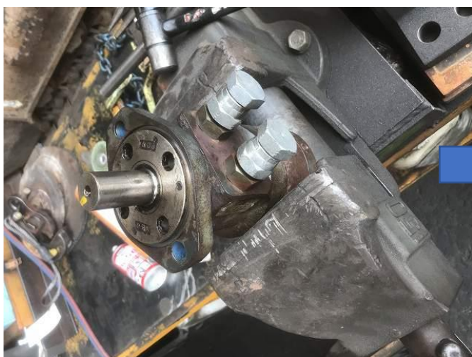
磁選機モーター油漏れ修理
