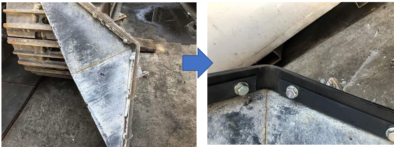
コンベア下部クリーナースクレーパゴム交換
