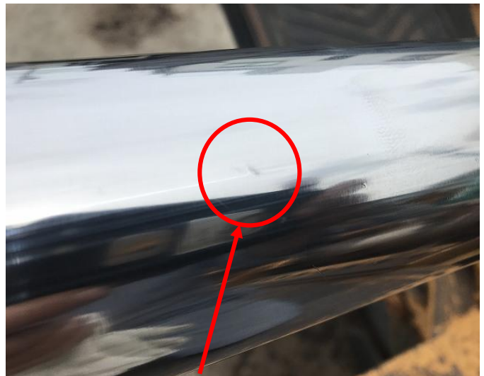
ホッパー開閉シリンダーロッド打痕
