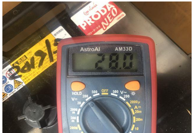
バッテリー電圧 (E/G始動後)
