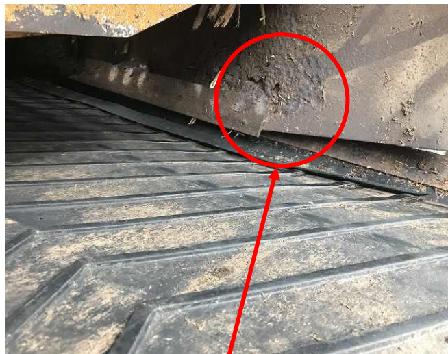
ベルトコンベアフレーム穴あき
