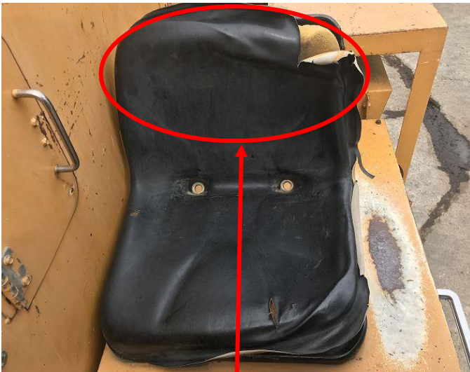
オペレーターシート破損
