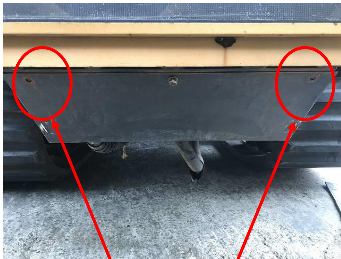
前側カバーボルト折れ込み
