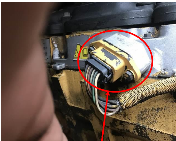
インジェクターノズル配線集合部分オイル洩れ
