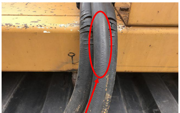
カッタードラム戻りホースひび割れ
