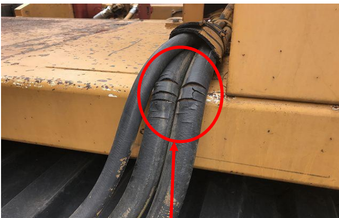
カッタードラムホースひび割れ
