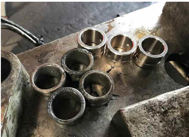
リンク内部ブッシュ&シール、ベアリング交換
