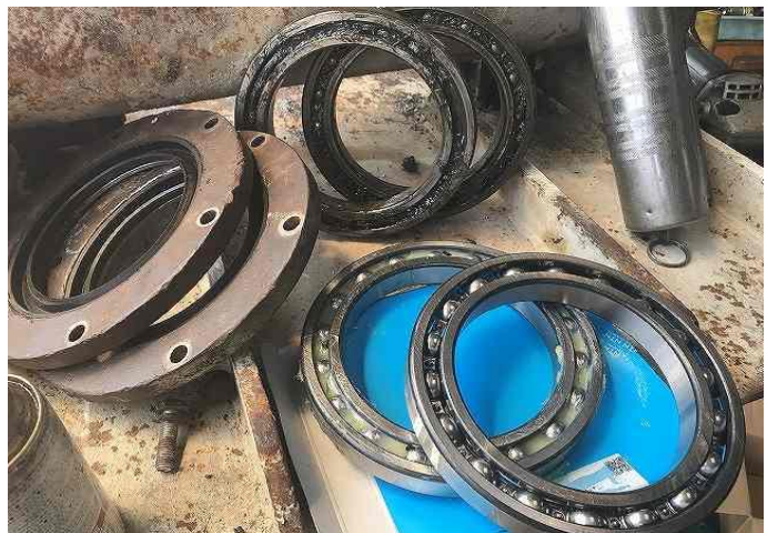
リンク内部ブッシュ&シール、ベアリング交換
