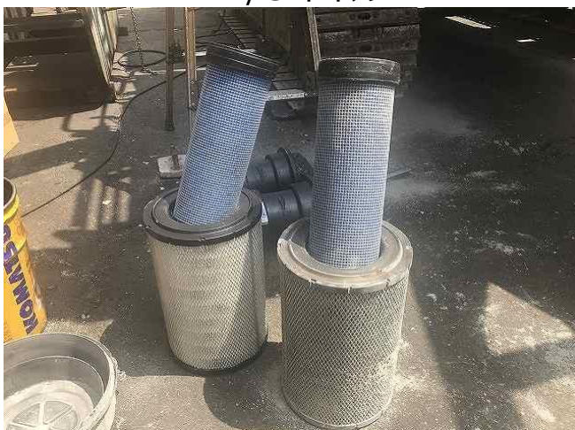
エアエレメント交換
