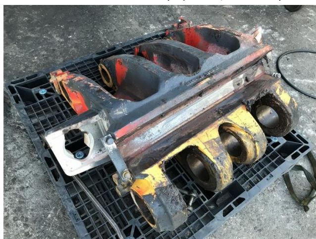
クラッシャーリンク取り外し
