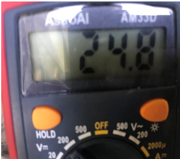
バッテリー電圧（E/G始動前）
