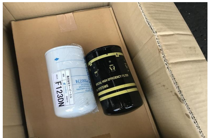
燃料エレメント交換
