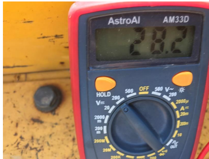
バッテリー電圧（E/G始動後）
