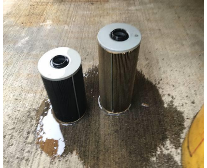
作動油エレメント交換
