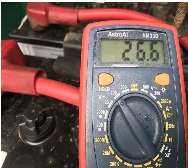
バッテリー電圧 (E/G始動前)
