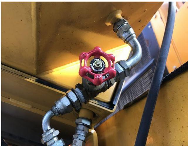
燃料タンク配管バルブ交換
