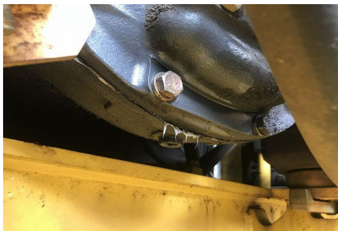
エンジンリアシール漏れ修理
