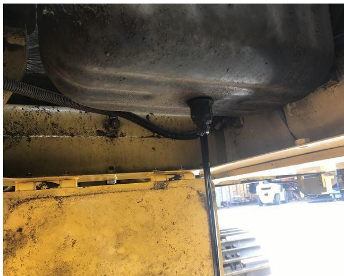
エンジンオイル、エレメント交換
