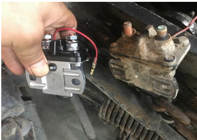
散水リレー交換
