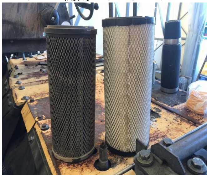
エアーエレメント交換
