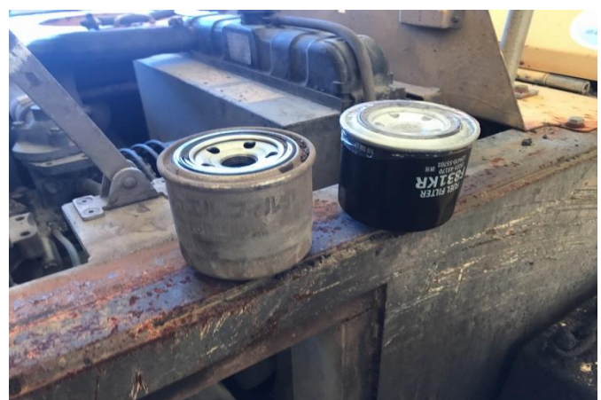
燃料エレメント交換
