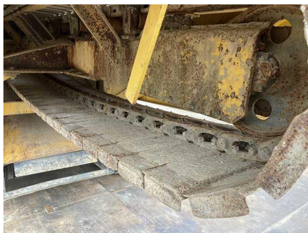
土砂フィーダープレート摩耗,ローラー類摩耗,リンク伸び
