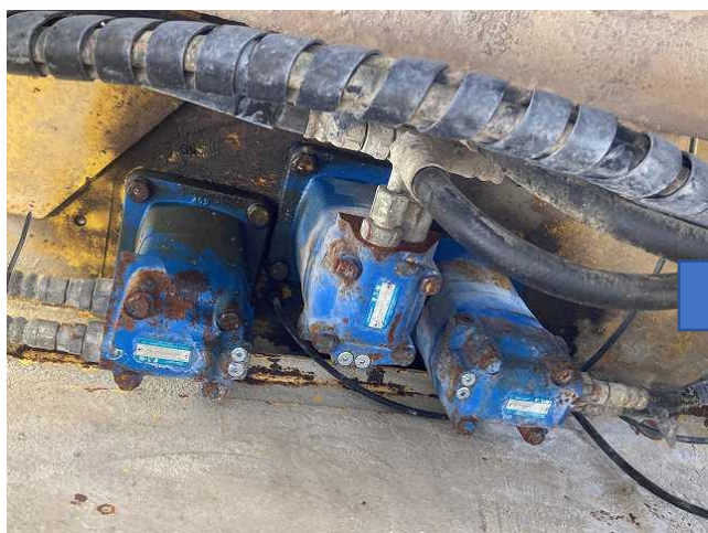
固化剤モータ交換(1個/社内在庫の中古品)
