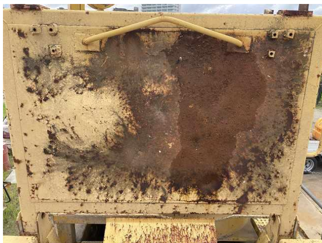
固化剤投入口開閉カバー錆び変形
