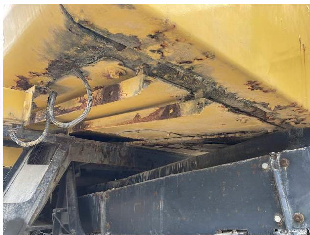
エンジンルーム下錆び腐食
