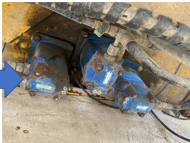
固化剤モータ交換(1個/社内在庫の中古品)
