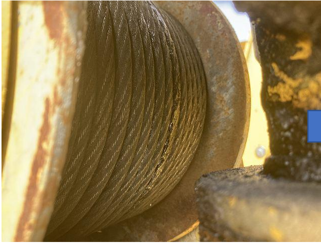
クレーンワイヤ乱巻き修正
