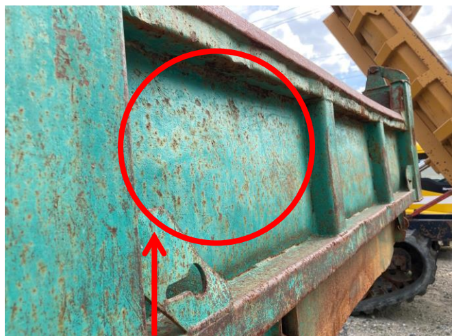
バッセルサイド突き出し変形
