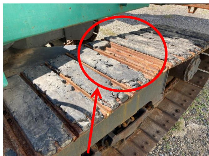
ゴムパット欠損
