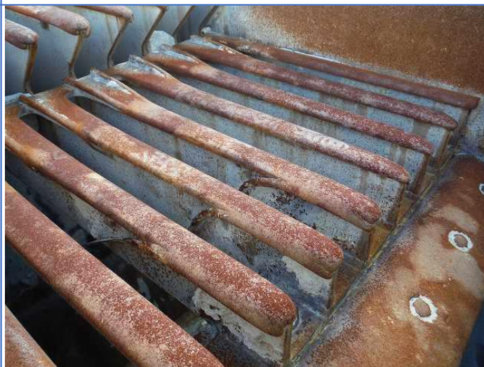
グリズリ摩耗によりサイド部めくれ
