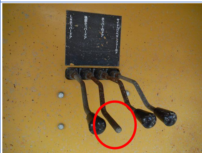
後方ホッパー開閉レバーノブ欠損
