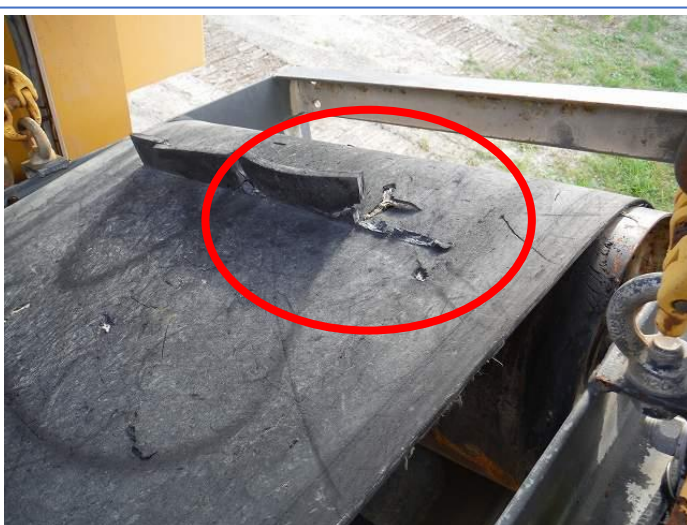
磁選機コンベアベルト部損傷
