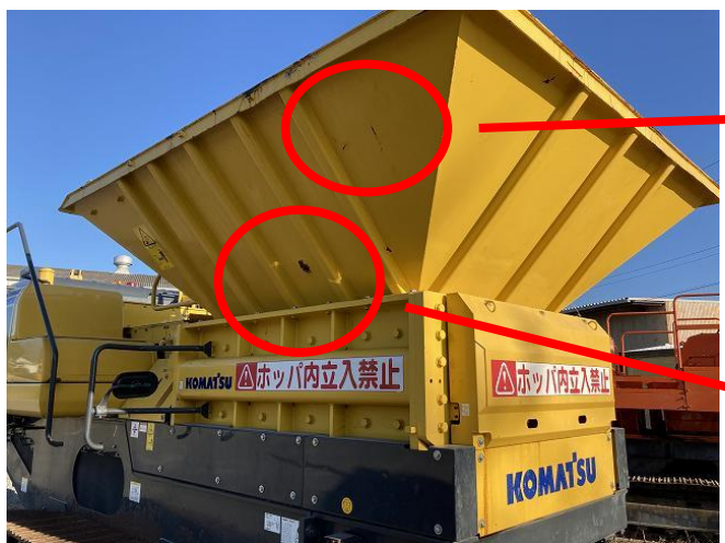
投入ホッパー突出し(左側)①
