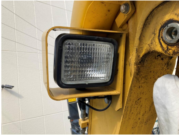
ブーム作業灯不灯
