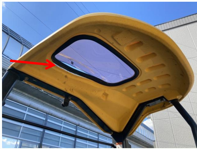
CNP天窓アクリル板破損 ①
