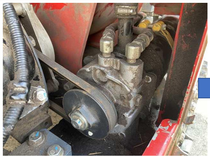
クラッチドライブベルト交換
