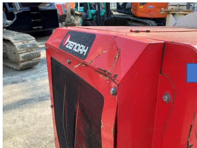
ラジエターグリル補修,防塵ネット交換
