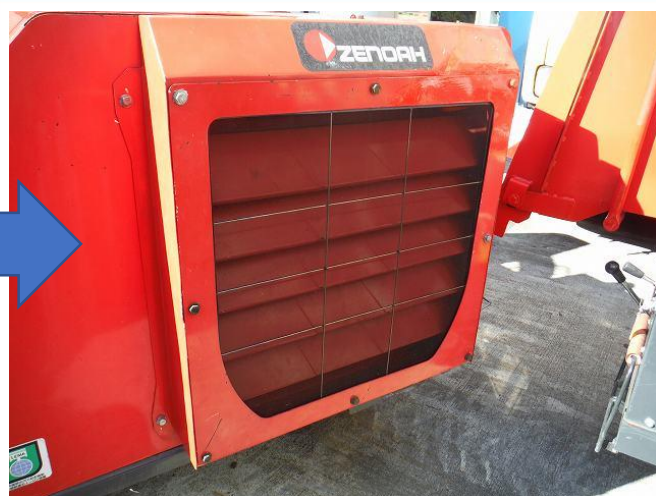
ラジエターグリル補修,防塵ネット交換
