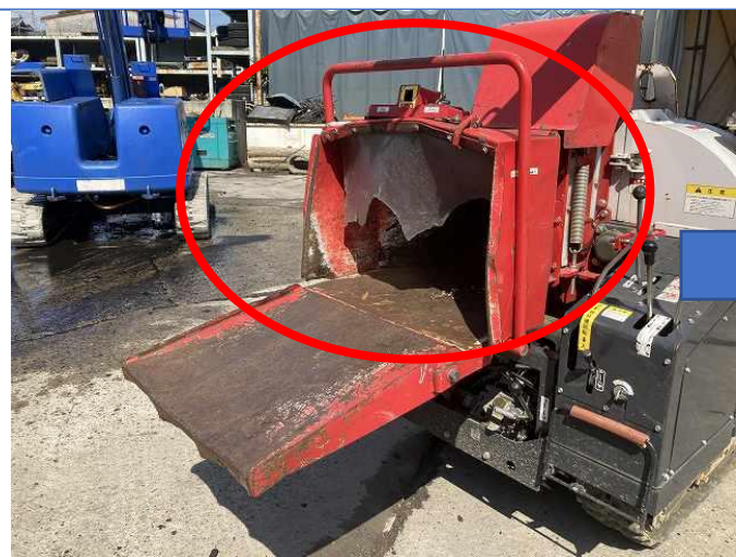
投入ホッパー変形板金修理
