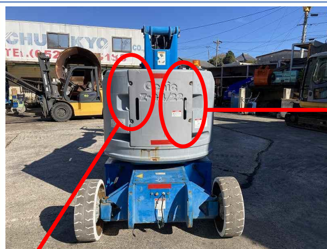
後方パネルカバー部分破損
