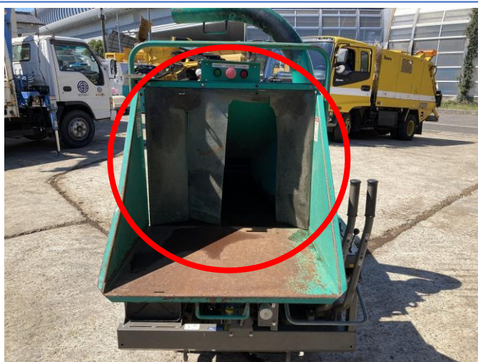
飛散防止カバー破損
