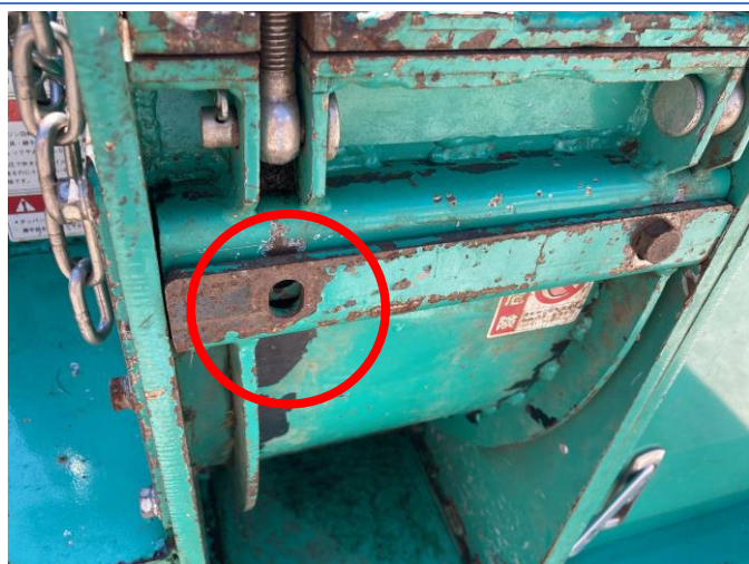
ローターカバーボルト欠損
