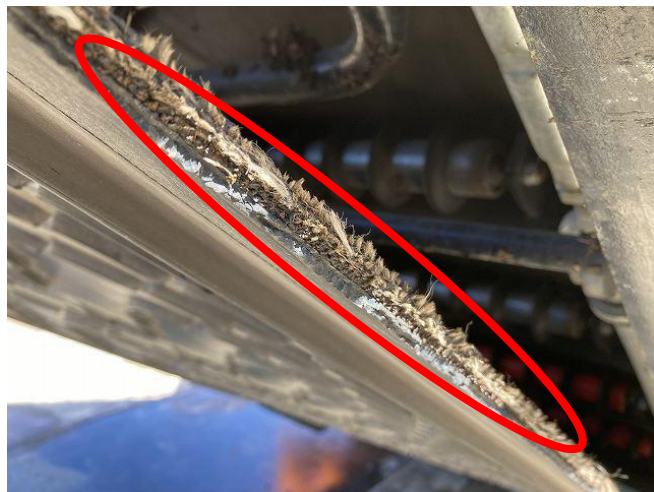
二次コンベヤベルト端部摩耗
