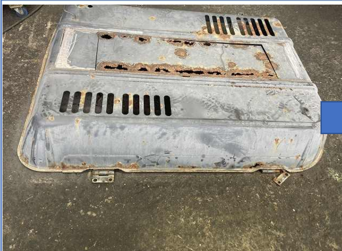
エンジンフード錆、腐食穴あきの為板金補修塗装
