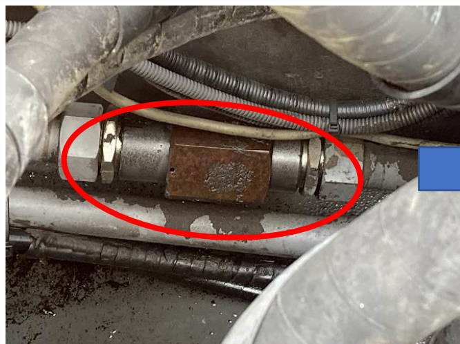
スローリターンバルブ1個不良のため交換
