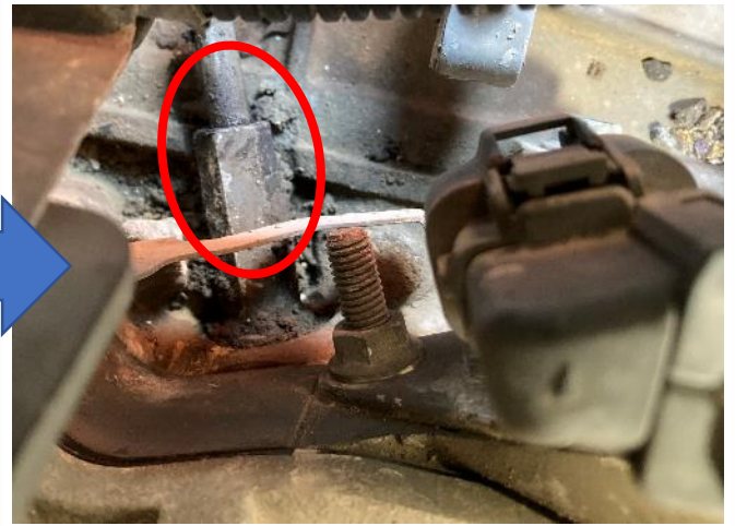
燃料高圧パイプ 燃料漏れ修理
