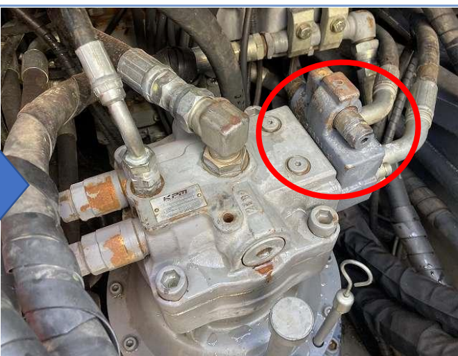
旋回モーターバルブ面油漏れの為修理
