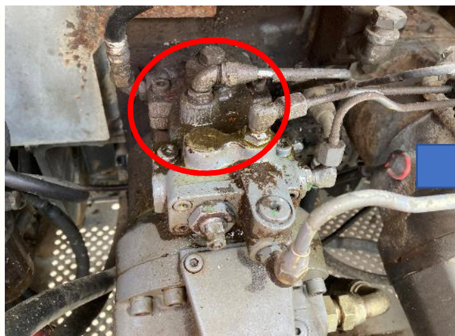
油圧ポンプレギュレーター油漏れ修理
