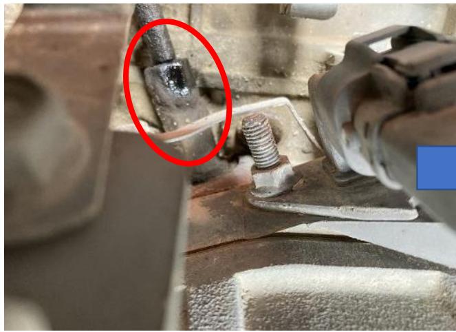
燃料高圧パイプ 燃料漏れ修理
