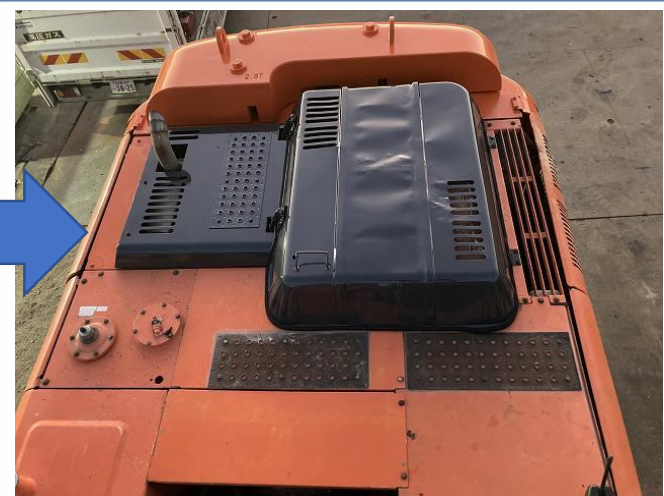
エンジンフード錆、腐食穴あきの為板金補修塗装
