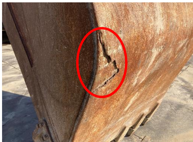
バケット底面 鋼板剥がれ
