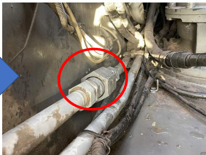
スローリターンバルブ1個不良のため交換
