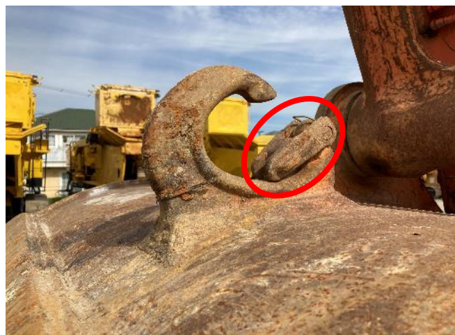
バケットフック ラッチ不良
