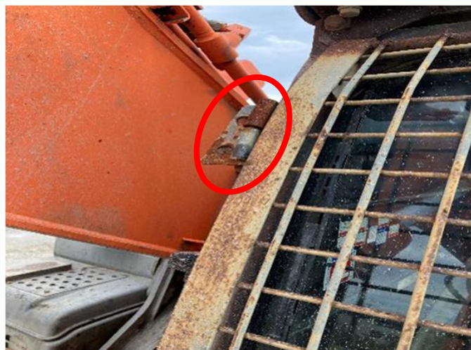
フロントガード蝶番ボルト欠損
