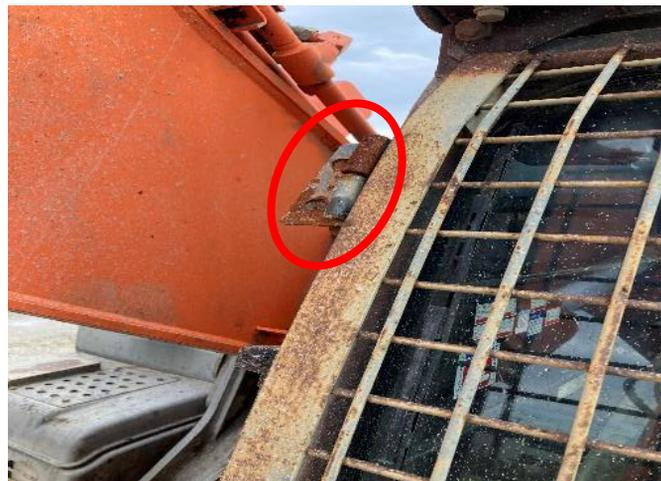
フロントガード ヒンジ部分破断
