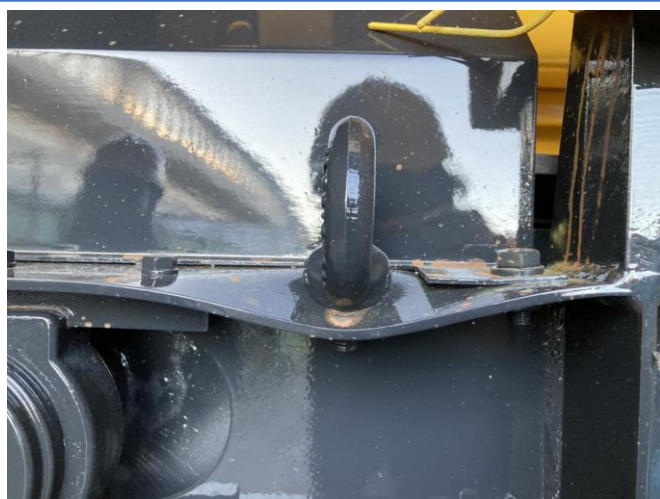
磁選機吊りポイント フレーム歪み③
