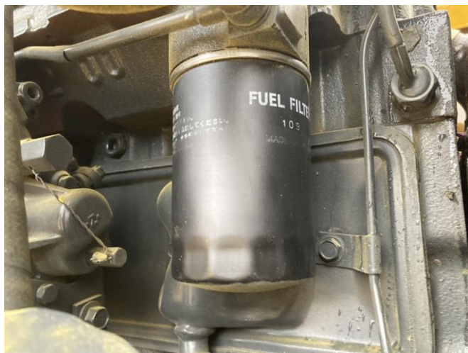
燃料エレメント交換
