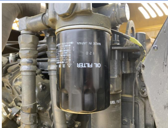
エンジンオイル、エレメント交換②
