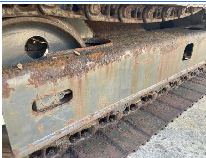
トラックフレーム錆腐蝕
