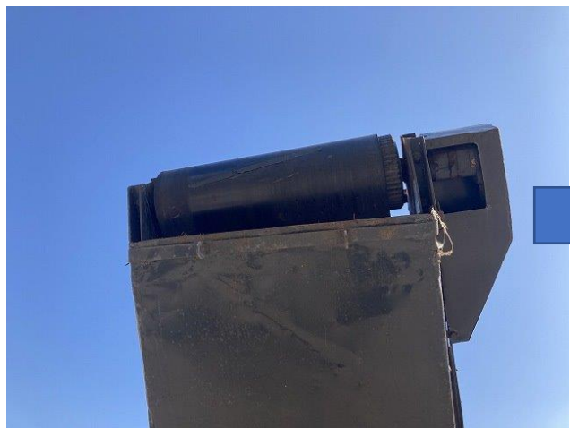
コンベアゴム偏り調整
