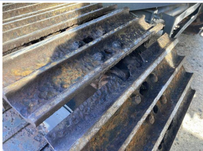
シュプレート 錆腐蝕
