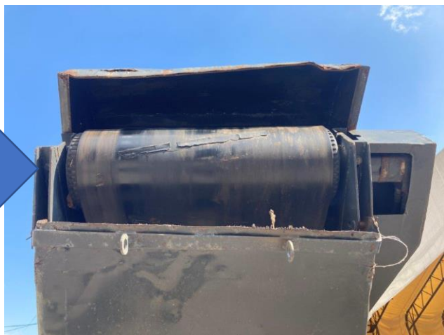
コンベアゴム偏り調整
