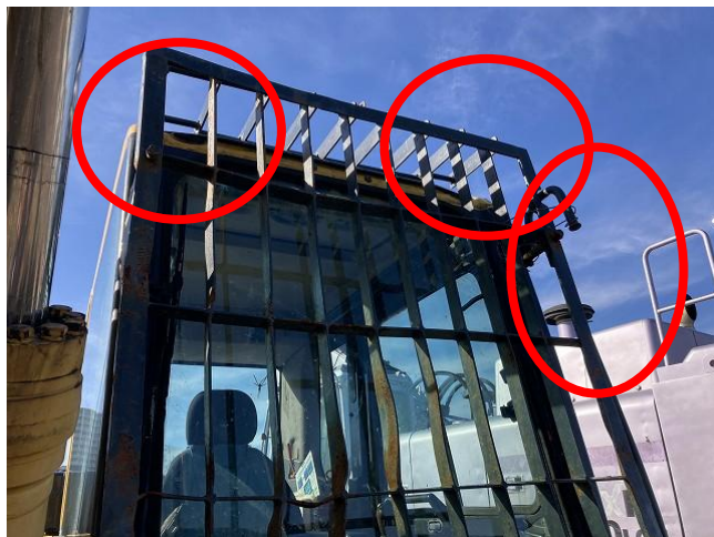
前照灯,ミラー欠損
