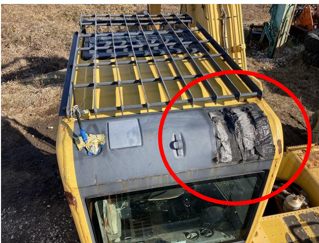
キャビンルーフ補修跡
