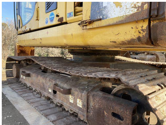
右側シューリンク伸び
