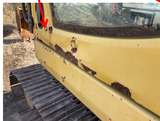
キャブドア腐食
