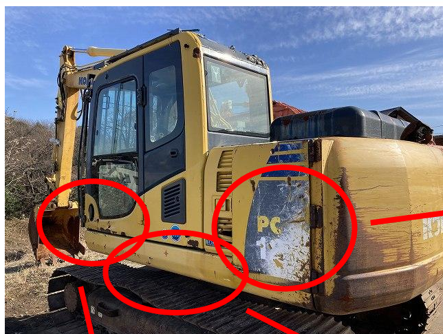
左側面損傷(全景)
