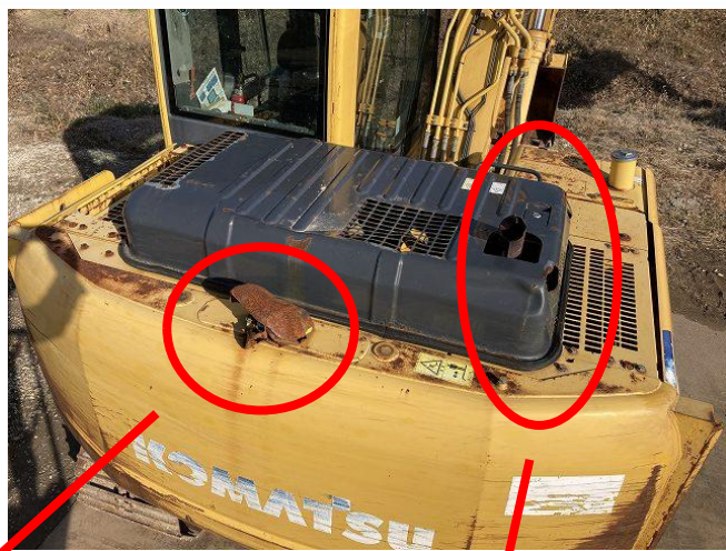
上部,背面損傷(全景)
