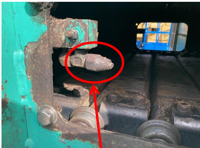
供給コンベアチェーンブリス配管欠損
