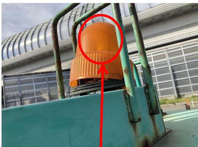
回転灯カバーひび割れ
