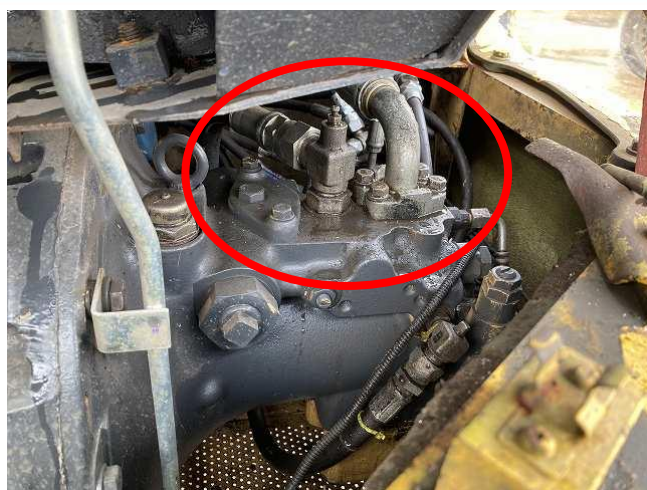
メインポンプホースより油漏れ
