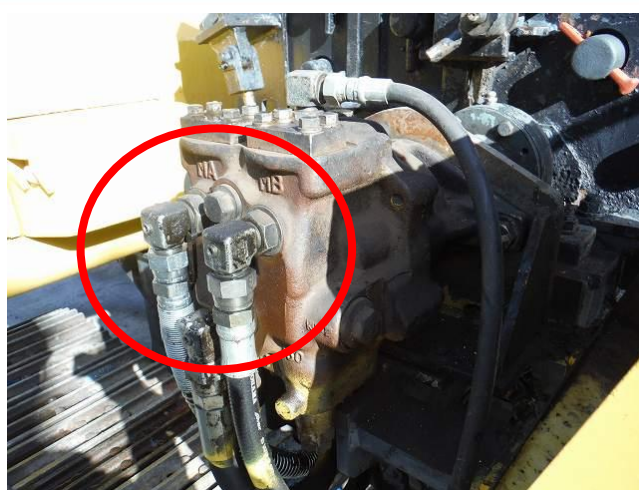
クラッチャモーターホース油漏れ
