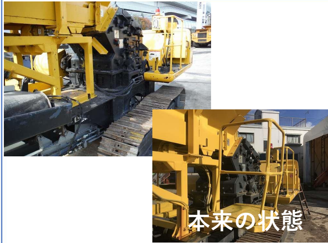
左側作業台欠損
