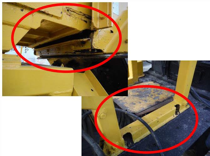
外装錆腐食②
