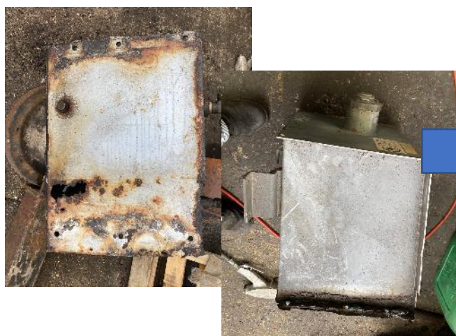
燃料タンク、作動油タンク溶接修理
