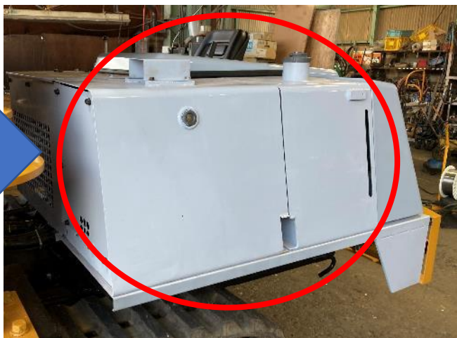
燃料タンク、作動油タンク溶接修理
