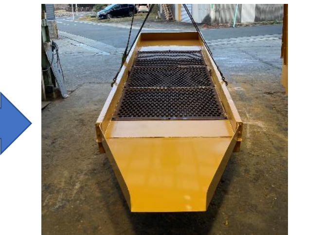
スクリーンデッキ 溶接板金・製作・塗装
