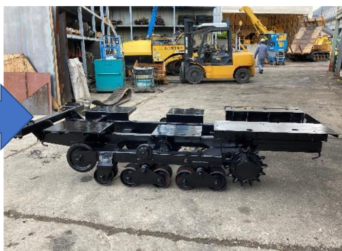
下部フレーム 溶接板金・製作・塗装
