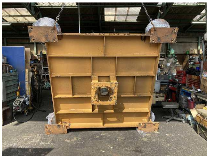
スクリーンデッキ脱着メインベアリング位置調整
