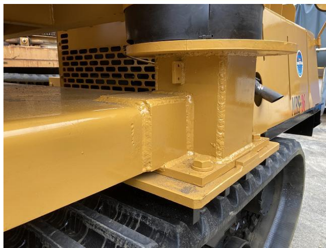
シャーシフレーム及びスクリーンフレーム再補強
