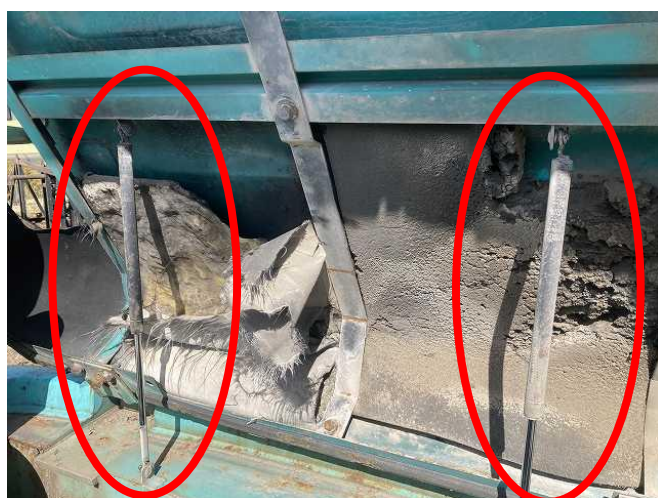
エンジンフードダンパー不良
