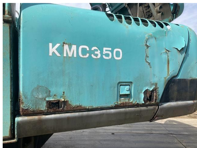
左サイドカバー腐食
