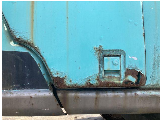
右サイドカバー腐食
