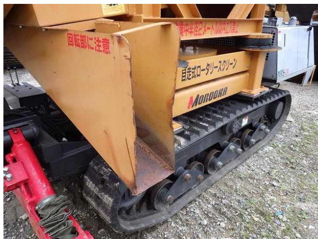
排出シューター(アンダー)変形
